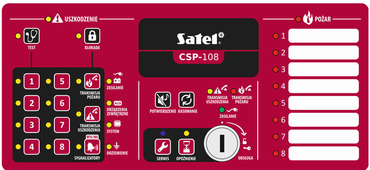
Rys. 6. Panel czołowy centrali CSP-108.
