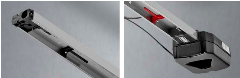
Przełącznik suwakowy określa pozycje krańcowe w obu kierunkach.
